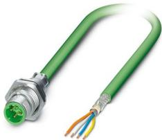
Connecteur mâle encastrable pour système de bus, PROFINET, 4 pôles, M12, blindé, détrompage D, SPEEDCONNEC, montage vissé/sur face arrière, filetage Pg9, câble bus de 2,0 m, 2 x 2 x 0,34 mm<sup>2</sup>
