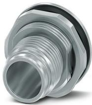
Presse-étoupe de boîtier, Connecteur mâle, M12-Push-Pull, Montage face arrière, M15 x 1, THR- und Wellenlötkontakte, L'article est sans plomb, conformément à la directive RoHS II, sans exception 6c (Pb < 0,1 %)
