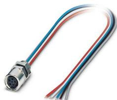
Embases paroi avant, DeviceNet™, 5-pôles, connecteur femelle, droit, M8, détrompage: B, Montage sur face avant, M8 x 0,5, Cordons individuels, longueur de câble: 0,5 m, 0,25 mm<sup>2</sup>, Cordon PVC
