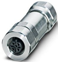
Connecteur, 5-pôles, blindé, connecteur femelle droit M12, détrompage: B, Raccordement vissé, matériau de la molette: Acier inoxydable 1.4404, presse-étoupe M16, diamètre extérieur du câble 5,5 mm ... 8,6 mm
