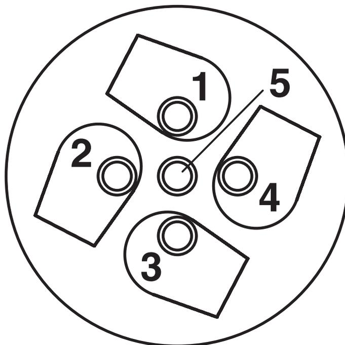
Côté connexion câble M12 (connexion vissée)
