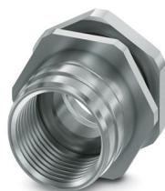
Presse-étoupe de boîtier, connecteur femelle, M12-Push-Pull, Montage sur face avant, M14 x 1, THR- und Wellenlötkontakte, L'article est sans plomb, conformément à la directive RoHS II, sans exception 6c (Pb < 0,1 %)
