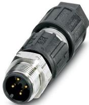
Connecteur, Universel, 4-pôles, connecteur mâle droit M12, détrompage: A, Raccordement autodénudant, matériau de la molette: Acier inoxydable 1.4404, diamètre extérieur du câble 3,5 mm ... 6 mm
