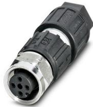
Connecteur, Universel, 4-pôles, connecteur femelle droit M12, détrompage: A, Raccordement autodénudant, matériau de la molette: Acier inoxydable 1.4404, diamètre extérieur du câble 3,5 mm ... 6 mm
