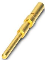
Contact à sertir, Mâle, tournés, diamètre de contact: 0,8 mm, zone de sertissage: 0,08 mm<sup>2</sup> ... 0,34 mm<sup>2</sup>, Produit de remplacement selon RoHS II sans exception 6c (Pb < 0,1 %) référence : 1239799
