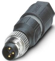
Connecteur, Universel, 3-pôles, connecteur mâle droit M8, détrompage: A, Raccordement autodénudant, matériau de la molette: Zinc moulé sous pression, nickelé, diamètre extérieur du câble 2,5 mm ... 5 mm
