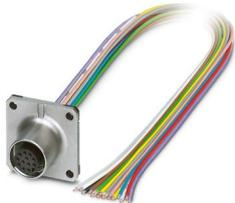
Embases paroi avant, Universel, 12-pôles, connecteur femelle, droit, M12, détrompage: A, sur extrémité libre, Montage sur face avant, Bride carrée, Cordons individuels, longueur de câble: 0,5 m, 0,34 mm<sup>2</sup>, Cordon TPE, Produit de remplacement selon RoHS II sans exception 6c (Pb < 0,1 %) référence : 1239724
