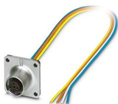
Embases paroi avant, Universel, 4-pôles, connecteur femelle, droit, M12, détrompage: D, sur extrémité libre, Montage sur face avant, Bride carrée, Cordons individuels, longueur de câble: 0,5 m, 0,34 mm<sup>2</sup>, Cordon TPE
