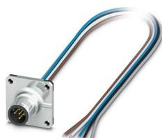
Embases paroi avant, Universel, 5-pôles, Connecteur mâle, droit, M12, détrompage: A, sur extrémité libre, Montage sur face avant, Bride carrée, Cordons individuels, longueur de câble: 0,5 m, 0,34 mm<sup>2</sup>, Cordon TPE
