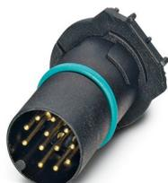
Porta-contatos, 12-pôles, Connecteur mâle, droit, M12, détrompage: A, Montage circuits imprimés, Raccordement soudé THR, Produit de remplacement selon RoHS II sans exception 6c (Pb < 0,1 %) référence : 1239758
