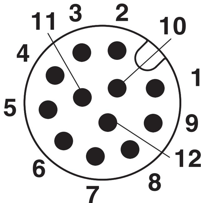
Brochage connecteur mâle M12, 12 pôles, détrompage A, vue côté connecteur mâle
