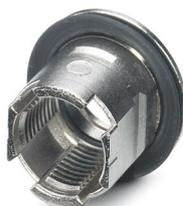
Connecteur femelle fileté M12 avec fonction de compensation des tolérances pour éléments de contacts de douilles M12 droits compatibles THR. Adapté aux panneaux avant de 1,0 mm ... 1,8 mm.
