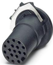
Porta-contatos, 17-pôles, connecteur femelle, droit, M12, détrompage: A, Montage circuits imprimés, Raccordement soudé THR, Produit de remplacement selon RoHS II sans exception 6c (Pb < 0,1 %) référence : 1239763
