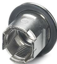
Connecteur femelle fileté M12 avec fonction de compensation des tolérances pour éléments de contacts de douilles M12 droits compatibles THR. Adapté aux panneaux avant de 3,1 mm ... 3,9 mm.
