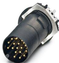
Connecteur mâle encastrable pour capteurs/actionneurs, 17 pôles avec tôle de blindage, détrompage A, avec raccord. soudé THR droit, uniqu. élément de contact
