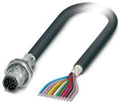
Connecteur d'appareil face arrière, Universel, 12-pôles, PVC/PVC, noir RAL 9005, blindé, Connecteur mâle, droit, M12-SPEEDCONNEC, détrompage: A, sur extrémité libre, Montage face arrière, M16 x 1,5, Raccordement de câble, longueur de câble: 1 m, 0,14 mm<sup>2</sup>, PVC noir, Produit de remplacement selon RoHS II sans exception 6c (Pb < 0,1 %) référence : 1239767
