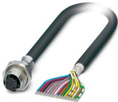
Connecteur d'appareil face arrière, Universel, 17-pôles, PVC/PVC, noir RAL 9005, blindé, connecteur femelle, droit, M12-SPEEDCONNEC, détrompage: A, sur extrémité libre, Montage face arrière, M16 x 1,5, Raccordement de câble, longueur de câble: 2 m, 0,14 mm<sup>2</sup>, PVC noir, Produit de remplacement selon RoHS II sans exception 6c (Pb < 0,1 %) référence : 1239770
