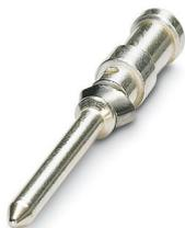
Contact à sertir, diamètre de contact: 1,6 mm, tournés, Mâle, matériau de contact: Alliage de cuivre, sans plomb, surface des contacts: plaqué argent, section raccordable: 0,14 mm<sup>2</sup> ... 0,34 mm<sup>2</sup>, AWG 26 ... 22
