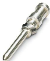
Contact à sertir, diamètre de contact: 1,6 mm, tournés, Mâle, matériau de contact: Alliage de cuivre, sans plomb, surface des contacts: plaqué argent, section raccordable: 2,5 mm<sup>2</sup> ... 2,5 mm<sup>2</sup>, AWG 14
