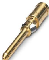
Contact à sertir, diamètre de contact: 1,6 mm, tournés, Mâle, matériau de contact: Alliage de cuivre, surface des contacts: doré, section raccordable: 0,5 mm<sup>2</sup> ... 0,5 mm<sup>2</sup>, AWG 20
