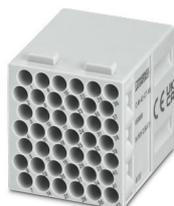
Module à élément de contact, nombre de pôles: 42, contacts de puissance: 0, contacts de commande: 42, Mâle, Raccordement à sertir, 150 V, 10 A, 0,14 mm<sup>2</sup> ... 2,5 mm<sup>2</sup>, application: Signal
