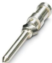
Contact à sertir, diamètre de contact: 1,6 mm, tournés, Mâle, matériau de contact: Alliage de cuivre, surface des contacts: plaqué argent, section raccordable: 0,5 mm<sup>2</sup> ... 0,5 mm<sup>2</sup>, AWG 20
