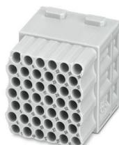
Module à élément de contact, nombre de pôles: 42, contacts de puissance: 0, contacts de commande: 42, Connecteur femelle, Raccordement à sertir, 150 V, 10 A, 0,14 mm<sup>2</sup> ... 2,5 mm<sup>2</sup>, application: Signal
