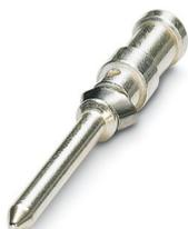
Contact à sertir, diamètre de contact: 1,6 mm, tournés, Mâle, matériau de contact: Alliage de cuivre, surface des contacts: plaqué argent, section raccordable: 0,14 mm<sup>2</sup> ... 0,37 mm<sup>2</sup>, AWG 26 ... 22
