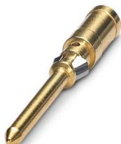
Contact à sertir, diamètre de contact: 1,6 mm, tournés, Mâle, matériau de contact: Alliage de cuivre, surface des contacts: doré, section raccordable: 1 mm<sup>2</sup> ... 1 mm<sup>2</sup>, AWG 18
