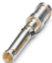
Contact à sertir, diamètre de contact: 1,6 mm, tournés, Connecteur femelle, matériau de contact: Alliage de cuivre, sans plomb, surface des contacts: plaqué argent, section raccordable: 0,75 mm<sup>2</sup> ... 0,75 mm<sup>2</sup>, AWG 18
