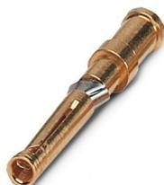
Contact à sertir, diamètre de contact: 1,6 mm, tournés, Connecteur femelle, matériau de contact: Alliage de cuivre, surface des contacts: doré, section raccordable: 1 mm<sup>2</sup> ... 1 mm<sup>2</sup>, AWG 18
