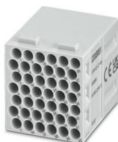
Module à élément de contact, nombre de pôles: 42, contacts de puissance: 0, contacts de commande: 42, Mâle, Raccordement à sertir, 150 V, 10 A, 0,14 mm<sup>2</sup> ... 2,5 mm<sup>2</sup>, application: Signal
