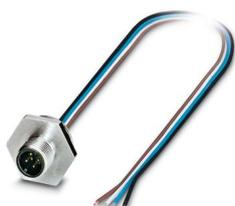
Embases paroi avant, 5-pôles, Connecteur mâle, droit, M12, détrompage: A, sur extrémité libre, Montage sur face avant, M20 x 1,5, Cordons individuels, longueur de câble: 0,5 m, 0,34 mm<sup>2</sup>, Cordon TPE
