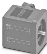
Connecteur pour électrovannes, Universel, 4-pôles, Connecteur de vanne AD (pressostat), Raccordement vissé, presse-étoupe M16, diamètre extérieur du câble 6 mm ... 8 mm
