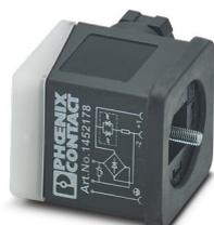
Connecteur pour électrovannes, Universel, 3-pôles, Connecteur de vanne A, Raccordement vissé, presse-étoupe M16, diamètre extérieur du câble 6 mm ... 8 mm
