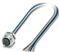
Embases paroi avant, Universel, 5-pôles, connecteur femelle, droit, M12, détrompage: B, sur extrémité libre, Montage sur face avant, Pg9, Cordons individuels, longueur de câble: 0,5 m, 0,34 mm<sup>2</sup>, Cordon TPE
