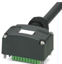
Capot de raccordement, application : Répartiteur pour capteurs/actionneurs, type de raccordement: Connecteur femelle M12 SPEEDCONNEX Plastique, nombre de prises: 4, affectation des prises: double, affichage d'état: Non; racc. câble multicond.: Raccordement vissé enfichable 180°, PUR/PVC, longueur du câble: 10 m, blindage: non
