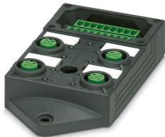
Répartiteur pour capteurs/actionneurs, embase, application : Standard, type de raccordement: Connecteur femelle M12 SPEEDCONNNEC Plastique, nombre de prises: 4, nombre de pôles: 5, détrompage: A, affectation des prises: double, affichage d'état: Oui, pnp; racc. câble multicond.: Raccordement vissé enfichable, blindage: non
