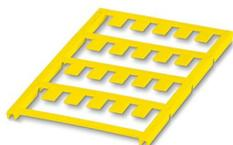
Etiquettes à encliqueter, à commander : sous forme de planche, jaune, impression selon les indications du client, type de montage: encliquetage dans le porte-repère, surface utile: 17,5 x 9 mm, Nombre d'étiquettes: 20
