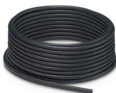
Câble principal pour répartiteurs pour capteurs/actionneurs, avec conducteur PE, non blindé, matériel PUR/PVC, 9 pôles, 6 x 0,34 mm<sup>2</sup> et 3 x 0,75 mm<sup>2</sup>
