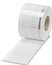
Repères pour câble, Rouleau, blanc, vierge, repérable avec : THERMOMARK E. 300 (D)/600 (D), THERMOMARK ROLL 2.0, THERMOMARK ROLL, THERMOMARK ROLL X1, THERMOMARK ROLLMASTER 300/600, THERMOMARK X1.2, type de montage: insertion, plage de diamètre de câble: 1,5 ... 35 mm, surface utile: 23 x 4 mm, Nombre d'étiquettes: 3000
