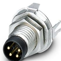
Connecteur d'appareil face arrière, Universel, 4-pôles, Connecteur mâle, droit, M8, Montage face arrière, M8 x 1, Soudage à la vague
