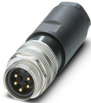
Connecteur, Universel, 5-pôles, connecteur mâle droit 7/8"-16UNF, détrompage: A, Raccordement vissé, matériau de la molette: Zinc moulé sous pression, nickelé, presse-étoupe Pg16, diamètre extérieur du câble 12 mm ... 14 mm, Contact 3 à fermeture
