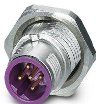
Connecteur d'appareil face arrière, 5-pôles, Connecteur mâle, droit, M12-SPEEDCONN, détrompage: B, Montage face arrière, Pg9, Picots de soudage, Produit de remplacement selon RoHS II sans exception 6c (Pb < 0,1 %) référence : 1239812
