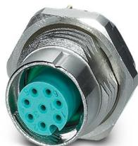
Connecteur d'appareil face arrière, 8-pôles, connecteur femelle, droit, M12-SPEEDCONNEC, détrompage: A, Montage face arrière, M16 x 1,5, Picots de soudage, Produit de remplacement selon RoHS II sans exception 6c (Pb < 0,1 %) référence : 1239819
