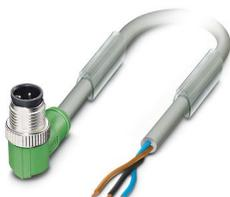
Câble pour capteurs/actionneurs, 3-pôles exempt d'halogène, ultra-souple, connecteur mâle coudé M12, détrompage: A, câblé avec déconnecté, sur extrémité libre, longueur de câble: 10 m, pour robots et chaînes porte-câbles
