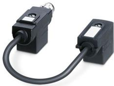
Adaptateur connecteur électrovanne double, Universel, 4-pôles, connecteur mâle coudé M12 SPEEDCONNEC, détrompage: A, sur Connecteur de vanne B (10 mm), avec 1 LED, câblé avec Diode zéner et Connecteur de vanne B (10 mm), avec 1 LED, câblé avec Diode zéner, écart entre connecteurs pour électrovanne: 0,2 m
