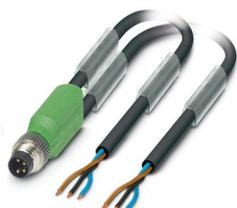
Câble pour capteurs/actionneurs, 3-pôles exempt d'halogène, connecteur mâle droit M8, détrompage: A, sur extrémité libre et extrémité libre, longueur de câble: 3 m
