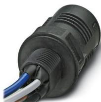
Traversée de paroi, Raccordement QUICKON, nombre de pôles: 4+PE, Mâle, 690 V, 20 A, noir, sans écrou QUICKON, filetage de montage: M20, Fils individuels (soudé), 2,5 mm<sup>2</sup>, fils coupés nets, longueur du câble: 0,5 m
