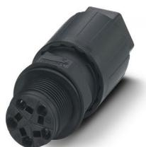
Traversée de paroi, Raccordement QUICKON, nombre de pôles: 4+PE, Mâle, 690 V, 20 A, noir, avec écrou QUICKON, diamètre extérieur du câble: 6 mm ... 11 mm, filetage de montage: M25, Raccordement Push-in
