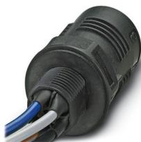
Traversée de paroi, Raccordement QUICKON, nombre de pôles: 4+PE, Mâle, 690 V, 20 A, noir, sans écrou QUICKON, filetage de montage: M25, Fils individuels (soudé), 2,5 mm<sup>2</sup>, fils coupés nets, longueur du câble: 0,5 m
