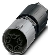
Connecteur, Raccordement QUICKON, nombre de pôles: 4+PE, 690 V, 20 A, noir, diamètre extérieur du câble: 6 mm ... 11 mm
