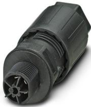
Traversée de paroi, Raccordement QUICKON, nombre de pôles: 4+PE, Mâle, 690 V, 15 A, noir, avec écrou QUICKON, diamètre extérieur du câble: 6 mm ... 11 mm, filetage de montage: M20, Raccordement par clips (pour clips selon DIN 46247-2)
