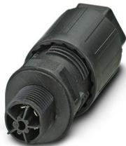
Traversée de paroi QUICKON, noire, 4 pôles +PE, 1,0 mm<sup>2</sup> à 2,5 mm<sup>2</sup> / 690 V / 20 A, avec écrou QUICKON, pour diamètres de câble 6 mm à 11 mm, filetage de raccordement M25 avec 5 contacts à languettes pour clips selon DIN 46247-2
