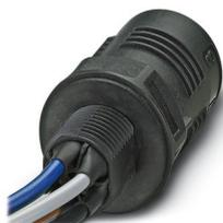
Traversée de paroi, Raccordement QUICKON, nombre de pôles: 4+PE, Mâle, 690 V, 20 A, noir, sans écrou QUICKON, filetage de montage: M20, Fils individuels (soudé), 2,5 mm<sup>2</sup>, fils coupés nets, longueur du câble: 1 m
