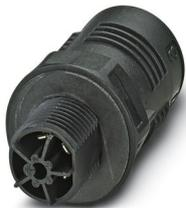
Traversée de paroi, Raccordement QUICKON, nombre de pôles: 4+PE, Mâle, 690 V, 20 A, noir, sans écrou QUICKON, filetage de montage: M25, Raccordement par clips (pour clips selon DIN 46247-2)
