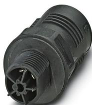
Traversée de paroi, Raccordement QUICKON, nombre de pôles: 4+PE, Mâle, 690 V, 15 A, noir, sans écrou QUICKON, filetage de montage: M20, Raccordement par clips (pour clips selon DIN 46247-2)
