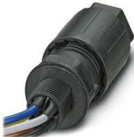
Traversée de paroi, Raccordement QUICKON, nombre de pôles: 4+PE, Mâle, 690 V, 20 A, noir, avec écrou QUICKON, diamètre extérieur du câble: 6 mm ... 11 mm, filetage de montage: M25, Fils individuels (soudé), 2,5 mm<sup>2</sup>, fils coupés nets, longueur du câble: 0,5 m
