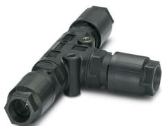
Répartiteur en T, Raccordement QUICKON, nombre de pôles: 4+PE, 690 V, 20 A, noir, avec 3 écrous QUICKON, diamètre extérieur du câble: 6 mm ... 11 mm
