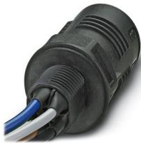
Traversée de paroi, Raccordement QUICKON, nombre de pôles: 4+PE, Mâle, 690 V, 20 A, noir, sans écrou QUICKON, filetage de montage: M25, Fils individuels (soudé), 2,5 mm<sup>2</sup>, fils coupés nets, longueur du câble: 1 m
