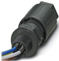
Traversée de paroi, Raccordement QUICKON, nombre de pôles: 4+PE, Mâle, 690 V, 20 A, noir, avec écrou QUICKON, diamètre extérieur du câble: 6 mm ... 11 mm, filetage de montage: M20, Fils individuels (soudé), 2,5 mm<sup>2</sup>, fils coupés nets, longueur du câble: 1 m
