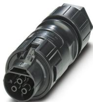
Connecteur prolongateur, Famille d'articles: PRC 35, type: droit, matériau du boîtier: PPE, coloris: noir, nombre de pôles: 3, section de fil min.: 1,5 mm<sup>2</sup>, section de fil max.: 6 mm<sup>2</sup>, tension de référence: 690 V AC, courant de référence: 35 A, Type de raccordement: Raccordement vissé, Type de contact: Connecteur femelle, diamètre de câble min.: 8 mm, diamètre de câble max.: 21 mm. Variante pour le déverrouillage manuel
