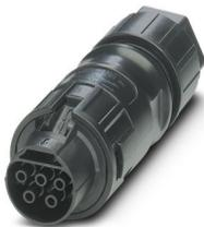
Connecteur prolongateur, Famille d'articles: PRC 35, type: droit, matériau du boîtier: PPE, coloris: noir, nombre de pôles: 5, section de fil min.: 1,5 mm<sup>2</sup>, section de fil max.: 6 mm<sup>2</sup>, tension de référence: 690 V AC, courant de référence: 35 A, Type de raccordement: Raccordement vissé, Type de contact: Connecteur femelle, diamètre de câble min.: 8 mm, diamètre de câble max.: 21 mm. Variante pour le déverrouillage manuel
