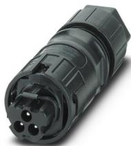
Connecteur, Famille d'articles: PRC 35, type: droit, matériau du boîtier: PPE, coloris: noir, nombre de pôles: 3, section de fil min.: 1,5 mm<sup>2</sup>, section de fil max.: 6 mm<sup>2</sup>, tension de référence: 690 V AC, courant de référence: 35 A, Type de raccordement: Raccordement vissé, Type de contact: Mâle, diamètre de câble min.: 8 mm, diamètre de câble max.: 21 mm. Garantit la protection contre les contacts avec les doigts
