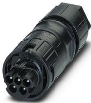
Connecteur, Famille d'articles: PRC 35, type: droit, matériau du boîtier: PPE, coloris: noir, nombre de pôles: 5, section de fil min.: 1,5 mm<sup>2</sup>, section de fil max.: 6 mm<sup>2</sup>, tension de référence: 690 V AC, courant de référence: 35 A, Type de raccordement: Raccordement vissé, Type de contact: Mâle, diamètre de câble min.: 8 mm, diamètre de câble max.: 21 mm. Garantit la protection contre les contacts avec les doigts
