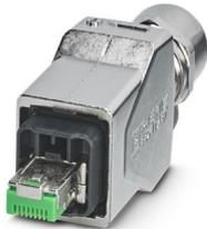
Connecteur RJ45, indice de protection: IP65/IP67, nombre de pôles: 2, CAT5 (CEI 11801:2002), matériau: Métal, type de raccordement: Raccordement autodénudant IDC, sortie du câble: droit, VARAN
