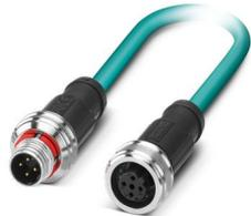
Câble de réseau, Ethernet CAT5 (100 Mbit/s), 4-pôles, blindé (Advanced Shielding Technology), connecteur mâle droit M12 Push-Pull, détrompage: D / IP67, sur Connecteur femelle droit M12 Push-Pull, détrompage: D / IP67, longueur de câble: 1 m
