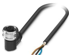
Câble pour capteurs/actionneurs, 3-pôles, PUR exempt d'halogène, gris-noir RAL 7021, blindé (Advanced Shielding Technology), extrémité libre, sur Connecteur femelle coudé M12 Push-Pull, détrompage: A, longueur de câble: 1,5 m
