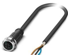
Câble pour capteurs/actionneurs, 3-pôles, PUR exempt d'halogène, gris-noir RAL 7021, blindé (Advanced Shielding Technology), extrémité libre, sur Connecteur femelle droit M12 Push-Pull, détrompage: A, longueur de câble: 1,5 m
