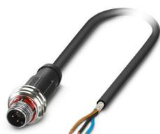
Câble pour capteurs/actionneurs, 3-pôles exempt d'halogène, blindé (Advanced Shielding Technology), connecteur mâle droit M12 Push-Pull, détrompage: A, câblé avec déconnecté, sur extrémité libre, longueur de câble: 10 m
