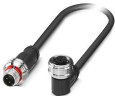
Câble pour capteurs/actionneurs, 3-pôles, PUR exempt d'halogène, gris-noir RAL 7021, blindé (Advanced Shielding Technology), connecteur mâle droit M12 Push-Pull, détrompage: A, câblé avec déconnecté, sur Connecteur femelle coudé M12 Push-Pull, détrompage: A, longueur de câble: 3 m
