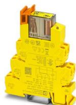
Relais de couplage sécurisé avec contacts à guidage forcé, isolation galvanique, 2 contacts inverseurs, à un canal, raccordement Push-in, largeur : 14 mm
