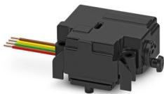
CHARX connect universal, Verrouillage, Accessoires, à brancher aux prises côté véhicule, Type 1, CEI 61851-1, Fils individuels, longueur: 1 m, actionneur de verrouillage: 12 V, 4 pôles
