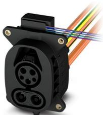
CHARX connect universal, Prise de raccordement côté véhicule, pour la recharge en courant continu (DC), CCS type 1, CEI 62196-2, CEI 62196-3, 200 A / 1000 V (DC), Fils individuels, longueur: 11 m, actionneur de verrouillage: 12 V, 4 pôles, Montage sur les parois avant et arrière, M6, boîtiers: noir, Pour les contacts DC, un cache de protection est fourni.
