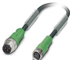
Câble pour capteurs/actionneurs, 4-pôles exempt d'halogène, connecteur mâle droit M12, détrompage: A, sur Connecteur femelle droit M8, longueur de câble: 5 m
