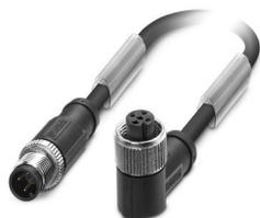
Câble pour capteurs/actionneurs, 3-pôles exempt d'halogène, blindé (Advanced Shielding Technology), connecteur mâle droit M12, détrompage: A, sur Connecteur femelle coudé M12, détrompage: A, longueur de câble: 3 m
