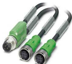
Câble pour capteurs/actionneurs, 3-pôles, connecteur mâle droit M12, détrompage: A, sur Connecteur femelle droit M12, détrompage: A et Connecteur femelle droit M12, détrompage: A, longueur de câble: 1 m
