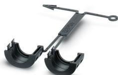
Clip de sécurité pour le côté connecteur femelle de câbles pour capteurs/actionneurs munis de connecteurs M12 et de connecteurs M12 à confectionner, pour écrous moletés de diamètre 15 mm, ou pour clé Allen de 14 mm, évite la séparation de raccords enfichables, sans outil
