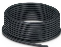
Câble principal pour répartiteurs pour capteurs/actionneurs, avec conducteur PE, non blindé, matériel PUR/PVC, 15 pôles, 12 x 0,50 mm<sup>2</sup> et 3 x 1,00 mm<sup>2</sup>, longueur : 50 m
