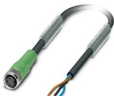
Câble pour capteurs/actionneurs, 3-pôles, extrémité libre, sur Connecteur femelle droit M8, détrompage: A, longueur de câble: 10 m
