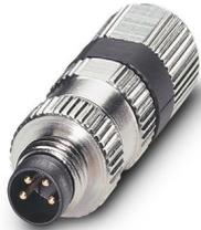
Connecteur, Universel, 4-pôles, connecteur mâle droit M8, détrompage: A, Raccordement rapide Piercecon<sup>®</sup>, matériau de la molette: Laiton, nickelé, diamètre extérieur du câble 3 mm ... 5 mm
